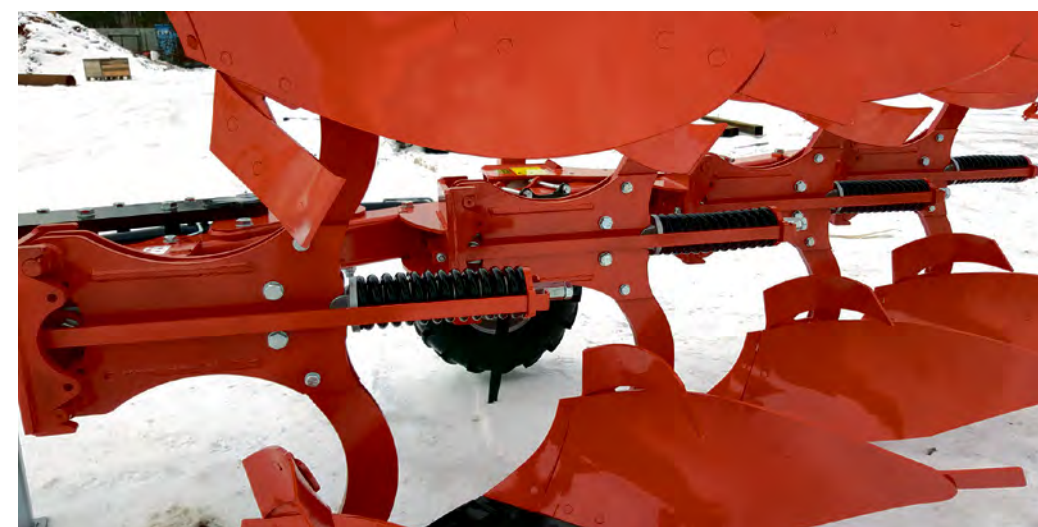
Zabezpieczenie sprężynowe NON STOP w pługu obracalnym
